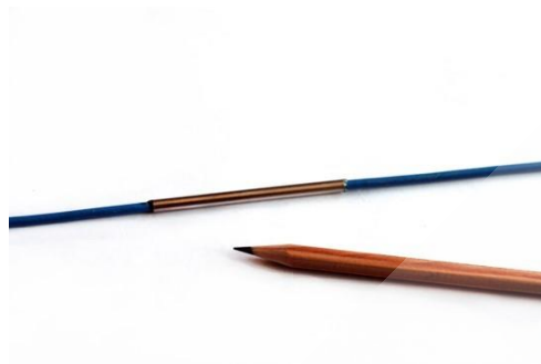
图 4.1.2-3 光纤光栅温度传感器
