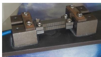
图 5.11.7-1 拉伸完成的传感器
